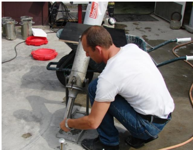
Figuur 10.21 Vul het vat met betonspecie. Bevestig daarna het bovenstuk en vul dit tot het waterpeil op de nulstreep staat. Schroef de hals dicht en schud de meter totdat alle lucht vrij gekomen is. Lees dan het luchtgehalte af. Beproeving volgens ASTM C 173 voor betonspecie met poreus toeslagmateriaal en/of beton- en menggranulaat.
