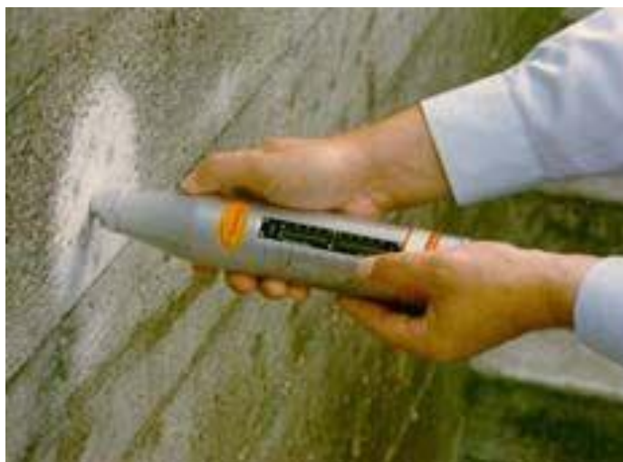
Figuur 10.24 De terugslaghamer: met een terugslaghamer wordt de mate van terugveren bepaald van een massa die door een gespannen veer tegen het betonoppervlak geschoten wordt. De mate van terugveren is een maat voor de sterkte-eigenschappen van het betonoppervlak. Beproeving volgens NEN-EN 12504-2.
