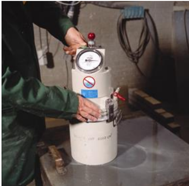
Figuur 10.20 De drukvatmethode: voor bepaling van het luchtgehalte met het drukvat wordt het vat met betonspecie gevuld die vervolgens wordt verdicht. Daarna wordt de drukkamer onder druk gebracht. Vervolgens wordt de drukkamer in verbinding gebracht met het meetvat. Het percentage lucht kan nu op de meter worden afgelezen. Beproeving volgens NEN-EN 12350-7 voor betonspecie met niet-poreus toeslagmateriaal.
