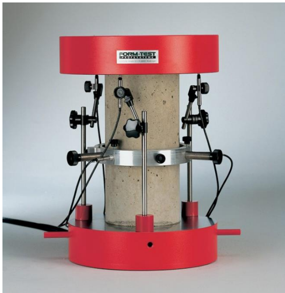
Figuur 10.29 Voor het bepalen van de elasticiteitsmodulus wordt een betonnen cilinderproefstuk langzaam belast tot maximaal 33% van zijn bezwijkkracht. Tijdens het aanbrengen van deze belasting wordt de vervorming van de cilinder gemeten. Uit de mate van vervorming in relatie tot de belasting die is aangebracht, wordt de E-modulus berekend.
