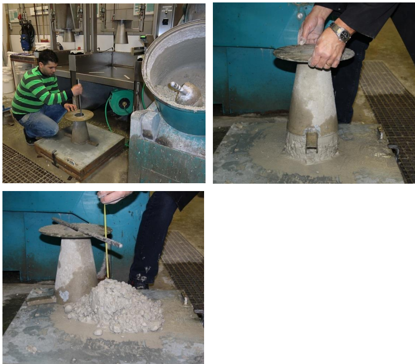
Figuur 10.13 De zetmaat: een kegel van 30 cm hoogte wordt in 3 lagen gevuld en per laag met een porstaaf verdicht. Na schoonmaken van de tafel wordt de kegel omhoog geheven en wordt de inzakking h gemeten nadat de kegel is verwijderd. De zetmaat is h (mm). Beproeving volgens NEN-EN 12350-2.
