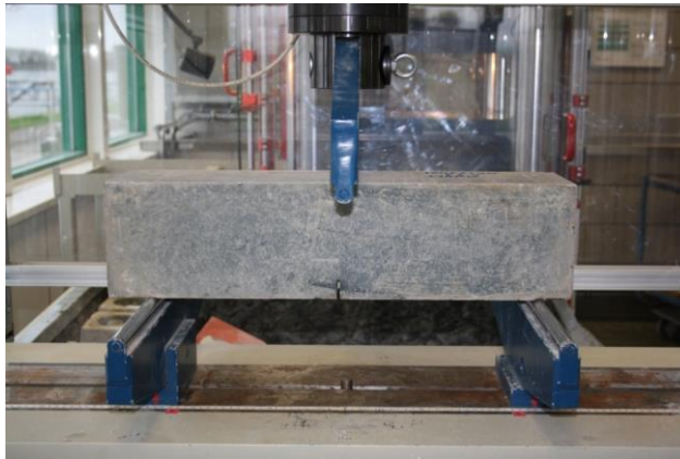
Figuur 10.27 De buigtreksterkte: kan worden bepaald aan prisma's met verschillende afmetingen. We onderscheiden daarbij tevens twee manieren van belasten. De zogenoemde driepunts- en de vierpuntsbuigproef. In sommige gevallen wordt bij de driepuntsbuigproef midden-onder in de balk een zaagsnede aangebracht.
