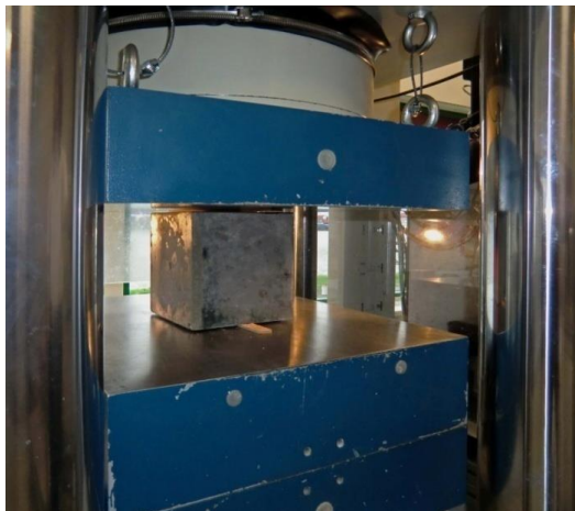
Figuur 10.28 De splijttreksterkte: wordt bepaald aan kubussen zoals die ook voor bepaling van de druksterkte worden toegepast. De kubussen worden in een drukpers geplaatst met tussen de vlakken van de kubus en de drukpersplaten een houten latje. De kubus wordt zodoende gespleten waarmee de splijttreksterkte kan worden berekend door de bezwijkbelasting te delen door het belaste oppervlak aan de hand van de volgende formule: f_{ct} = \frac{2F}{\pi \cdot l \cdot d}
