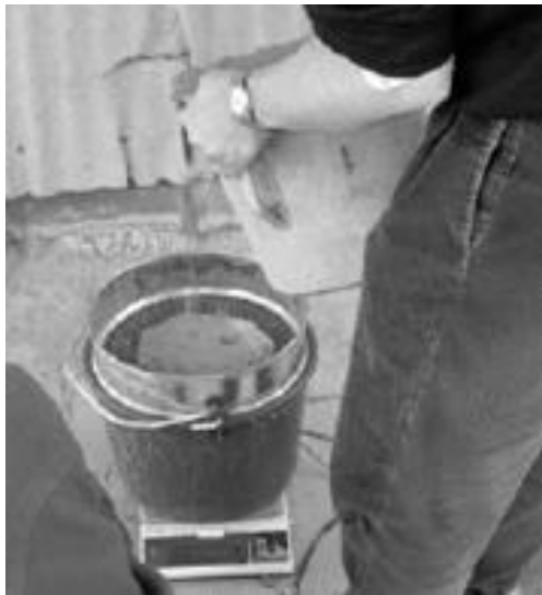
Figuur 10.18 Zeefsegregatietest: met deze test wordt bepaald hoeveel specie, nadat deze specie gedurende 15 minuten is weggezet in een emmer, er door een zeef van 5 millimeter zakt in een tijdsbestek van 120 seconden. Beproeving volgens NEN-EN 12350-11.
