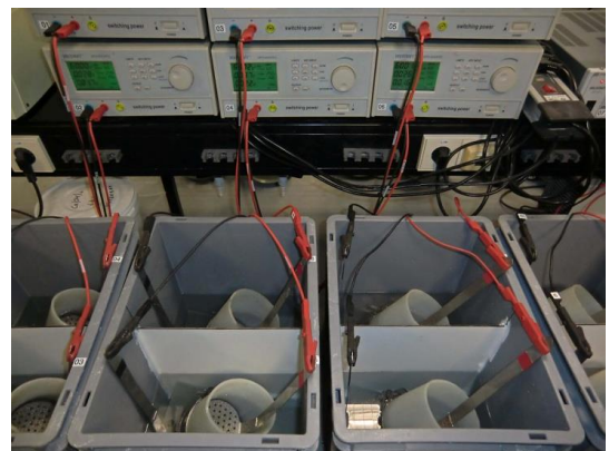
Figuur 10.30 Voor het bepalen van de RCM wordt over een betonproefstuk een spanningsverschil aangebracht. Het proefstuk staat met één zijde in een chloride-oplossing. Door het spanningsverschil worden de chloride-ionen geforceerd het beton in getrokken. Op basis van de mate van indringing van de chloriden, de tijdsduur van de meting en de hoogte van het spanningsverschil kan de weerstand van het beton tegen indringing van chloriden (RCM) worden berekend.
