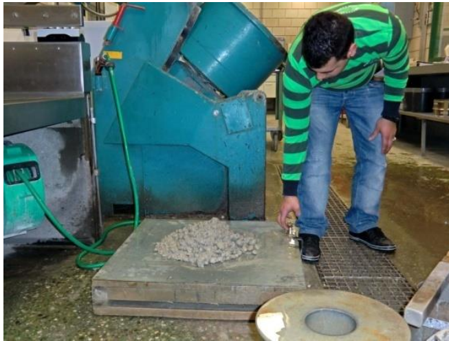
Figuur 10.14 De schudmaat: een kegel van 20 cm hoogte wordt in 2 lagen gevuld en per laag verdicht met een stamper. Na het schokken van de tafel worden de diameters d_1 en d_2 van de 'speciekoek' in twee, loodrecht op elkaar staande richtingen gemeten. De schudmaat is het gemiddelde van d_1 en d_2 (mm). Beproeving volgens NEN-EN 12350-5.
