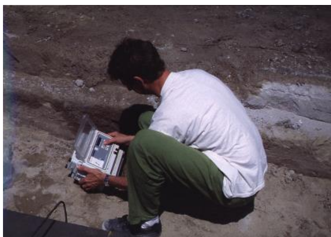
Figuur 10.23 De methode gewogen rijpheid: met behulp van sensoren in het verhardend beton wordt het temperatuurverloop in de constructie gevolgd en de gewogen rijpheid van beton daaruit uitgerekend. Op basis van een ijkgrafiek waarin de relatie tussen rijpheid en sterkte is weergegeven, kan een inschatting van momentane betonsterkte worden gemaakt. Beproeving volgens NEN 5970. (op de foto is een rijpheidscomputer afgebeeld)
