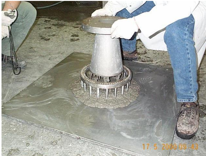
Figuur 10.19 Blokkeringsmaat met J-ring: op het moment dat de kegel geheven wordt, wordt de uitstroming geleid door een ring van stalen spijlen. Vervolgens wordt de hoogte van de betonspecie ten opzichte van de bovenkant ring in het midden en op vier punten buiten de ring gemeten. Bj is de gemiddelde hoogte buiten de ring minus de hoogte in het midden. Beproeving volgens NEN-EN 12350-12.
