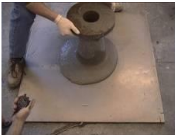
Figuur 10.15 De vloeimaat: een kegel van 30 cm hoogte wordt in een keer gevuld. Na schoonmaken van de tafel wordt de kegel geheven. Zonder verder energie toe te voeren worden ook hier de diameters d_1 en d_2 van de 'speciekoek' in twee, loodrecht op elkaar staande richtingen gemeten. De vloeimaat is het gemiddelde van d_1 en d_2 (mm). Beproeving volgens NEN-EN 12350-8.
