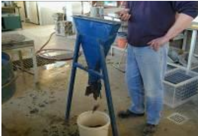
Figuur 10.16 De trechtertijd: Hiervoor wordt na het vullen van de trechter met zelfverdichtende betonspecie de tijd (t) gemeten die verstrijkt tussen het moment dat de klep onder wordt geopend en het moment dat het reservoir volledig leeg is. Beproeving volgens NEN-EN 12350-9.
