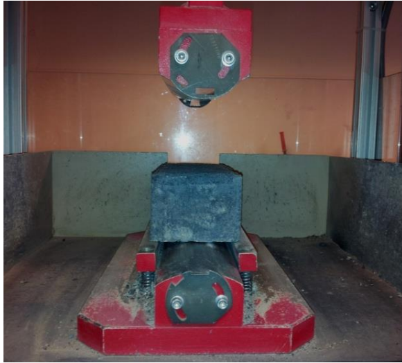
Figuur 10.31 Bepaling van de splijttreksterkte van betonstraatstenen.
