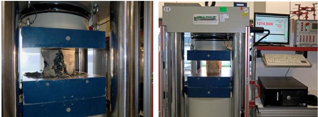
Figuur 10.25 De kubusdruksterkte: wordt gemeten aan eerder, volgens een omschreven procedure (NEN-EN 12390-2), vervaardigde kubussen met meestal afmetingen van 150 mm x 150 mm x 150 mm. Door de kubus te belasten in een pers kunnen we de kracht meten die nodig is om de kubus te laten bezwijken. De druksterkte ( N/mm^2 ) wordt vervolgens berekend door de bezwijkbelasting ( N ) te delen door het belaste oppervlak ( mm^2 ). Beproeving volgens NEN-EN 12390-3. De snelheid van belasten is voorgeschreven: 0,6 \pm 0,2 MPa/s.
