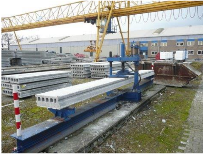
Figuur 10.33 Bepaling van de buigtreksterkte van een kanaalplaatvloer.
